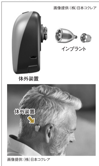
図8 装置と装着イメージ(骨固定型補聴器)
