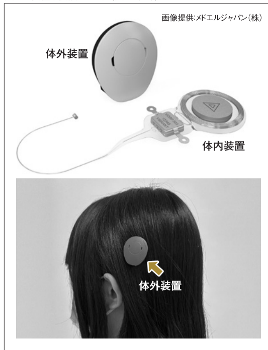
図8 装置と装着イメージ(骨固定型補聴器)
