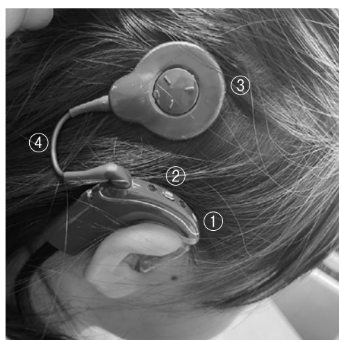
①マイク、②スピーチプロセッサ、③送信コイル、④ケーブル
